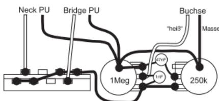
Der 1nF Kondensator ist als Volume-Kondensator geschaltet und kann je nach Geschmack auch weggelassen werden. Der Ton-Kondensator hat im Original 47nF, besser sind 15nF oder 22nF. Als Volume-Poti kann man auch 250k nehmen, dann wird der Sound etwas weicher.
